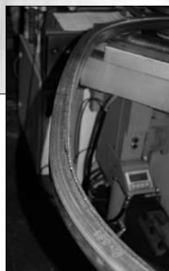
3-Rollen CNC gesteuerte Profilwalze bei der Fertigung eines Rahmenprofils für den Kabinenbau
