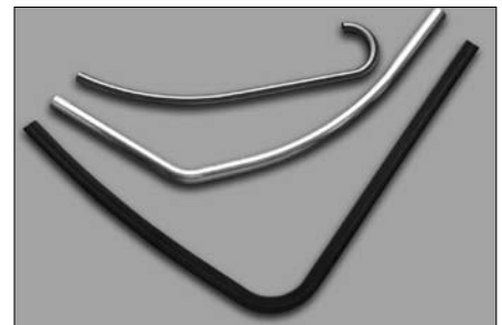
Einige Beispiele von bei Schuster hergestellten Biegeteilen mit mindestens zwei unterschiedlichen Biegeradien in Folge
