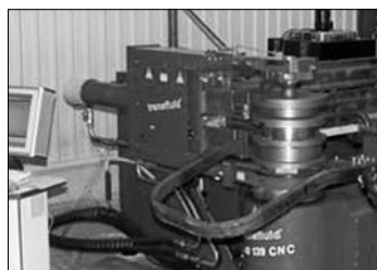
Die 139er CNC-gesteuerte Mehrradien-Biegemaschine bei der Fertigung eines Überrollbügels aus Stahlbauhohlprofil EN 10210 Werkstoff S355J2H mit Rohrabmessung 90 x 50 x 6,3 mm. Zwei 90°-Biegungen über die leichte Achse und zwei 20°-Biegungen über die schwere Achse in einer Aufspannung
